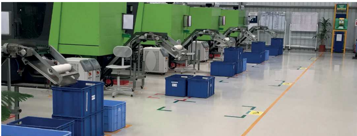
Organisation complète du site dans le respect de la méthode 5S - Localisation des caisses et des palettes en sortie de machine
