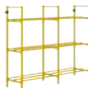
Porte cartable. Structure soudée. Pièment en tube 35/20 ép.1.5 mm et entretoise 20x20 ép.1,5 mm, revêtu époxy. L170xP42xH140 cm.
