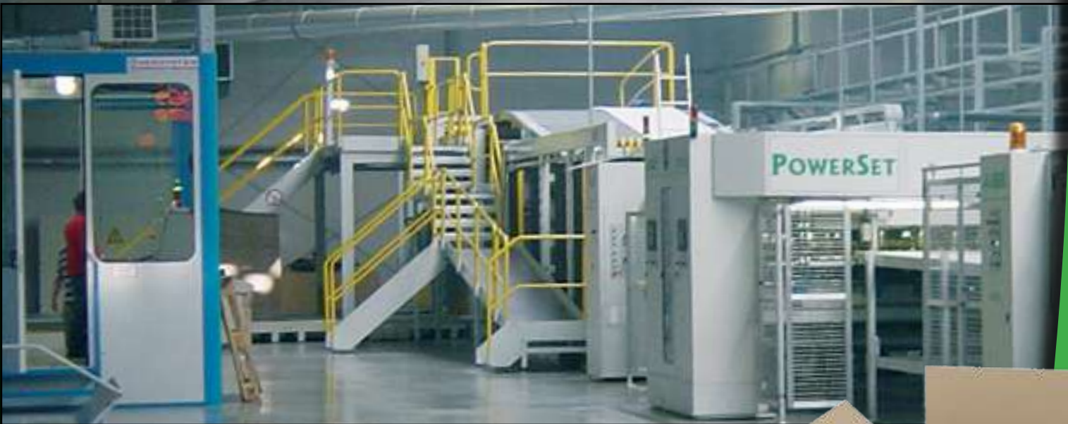
Installation pour la fabrication de carton ondulé simple ou double cannelure
