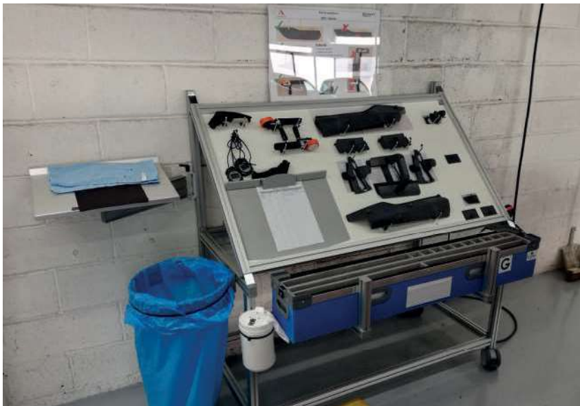
Poste de gabarit de perçage en bord de ligne
