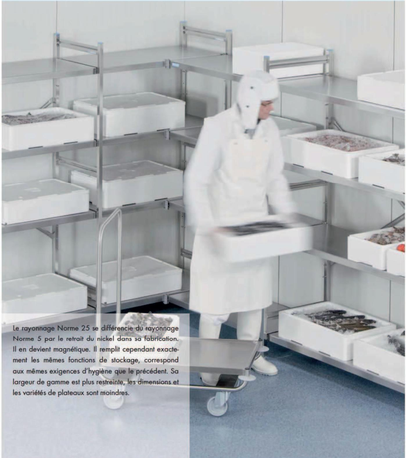
Le rayonnage Norme 25 se différencie du rayonnage Norme 5 par le retrait du nickel dans sa fabrication. Il en devient magnétique. Il remplit cependant exactement les mêmes fonctions de stockage, correspond aux mêmes exigences d'hygiène que le précédent. Sa largeur de gamme est plus restreinte, les dimensions et les variétés de plateaux sont moindres.
