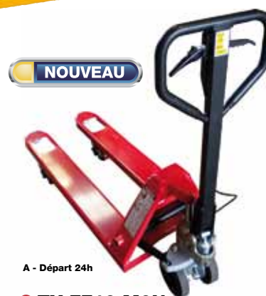
5 TX FF10 MON Transpalette à frein Système de frein à tambours, commande sur timon. Permet un freinage progressif ou un arrêt total par blocage des roues Charge 2500 kg.
