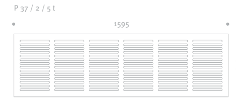
FERMO P 40 . Grille pour regard de visite et passage de rigoles
