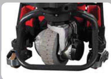
Roue directrice en caoutchouc cranté offrant une plus grande adhérence, un plus grand confort et limitant le bruit
