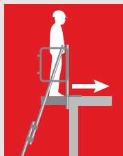
Plate-forme accès dalle
