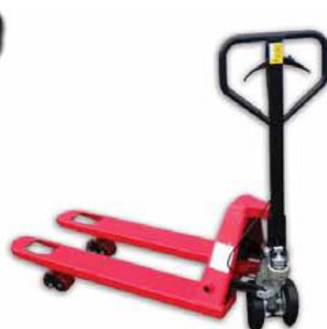
3 TX FF10 M0N à frein. Frein à tambour, commande sur timon : permet un freinage progressif ou un arrêt total par blocage des roues.
